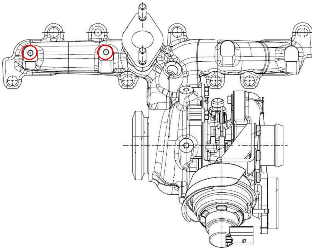
Por lo tanto **792290-5003S** reemplaza al turbo **792290-5002S** directamente solo cuando se usa en conjunto con el nuevo protector de calor. ( Este protector de calor lo suministra TurboMaster con la referencia **211033**)
