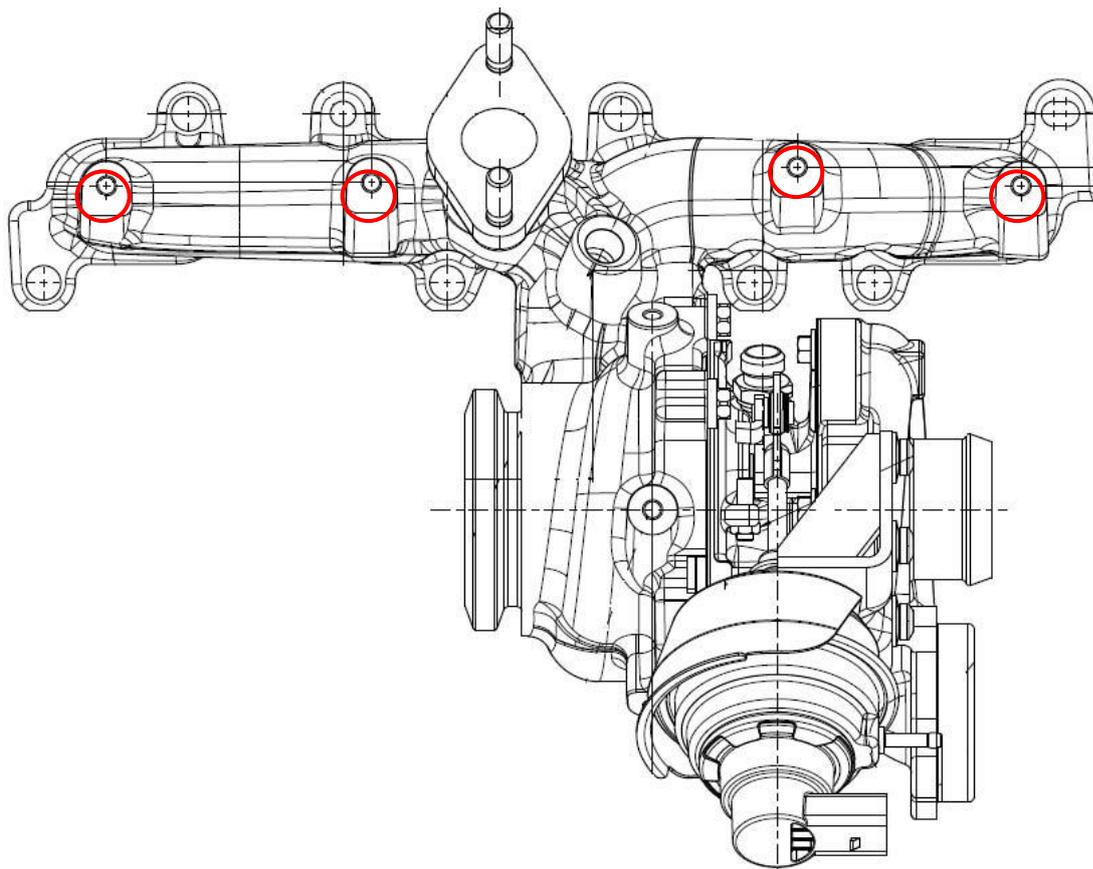
Sin embargo el nuevo turbo **792290-5003S** que reemplaza al anterior solo tiene 2 tornillos M6 para anclarse al colector de escape del turbo como se indica en el dibujo inferior:
