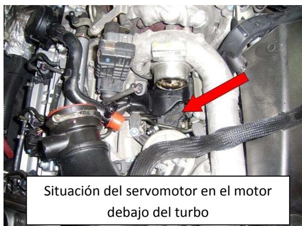
Situación del servomotor en el motor
