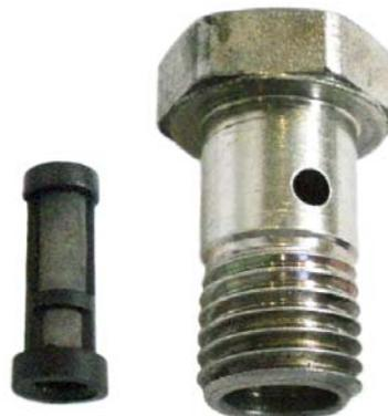
El racor atornillado al bloque del latiguillo de entrada de aceite, tiene en su interior un filtro muy fino que tiende a obstruirse. Cuando esto ocurre se produce la rotura del turbo por falta de lubricación.
