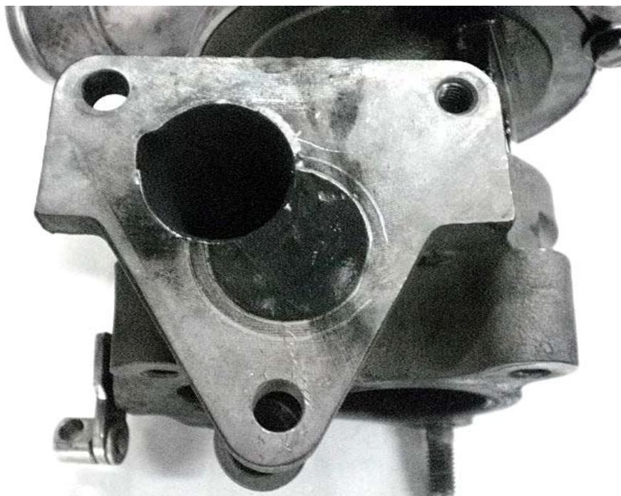
*Turbo con la junta mal montada, observen la marca que dejan los gases de escape sobre la parte sólida de la caracola de escape.*
