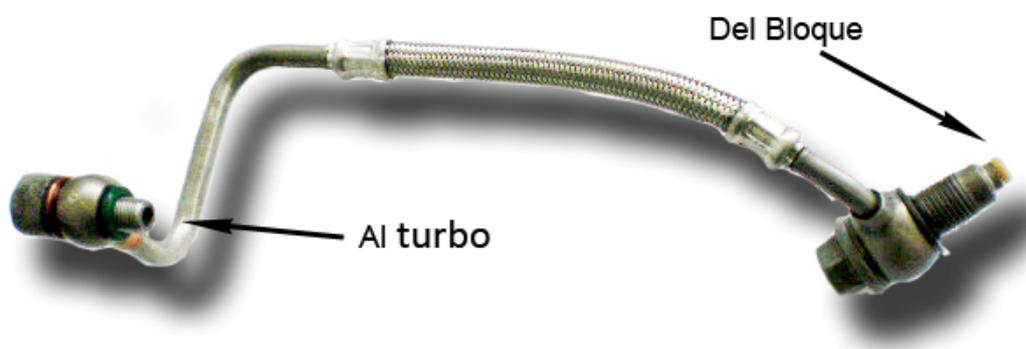
En la imagen superior vemos **el latiguillo de engrase del turbo**, con el extremo que acopla en el turbo y el extremo que ajusta en el bloque del motor.
